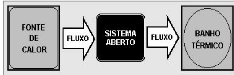
Figura A.1: Esquematização de um sistema aberto com fonte de calor e banho térmico (figura modificada de [21], pag. 26)
