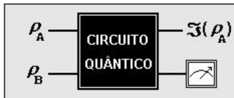
Figura 3.1: Circuito representando uma Operação Quântica (figura modificada de [8], pag. 362)
